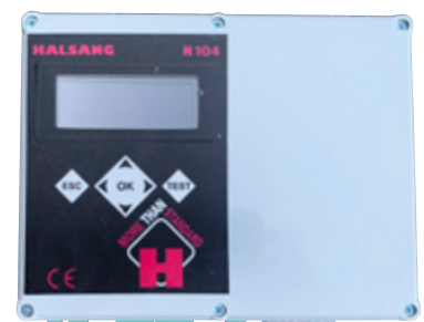
Armoire électrique équipée d'un contrôleur Halsang H104 et de modulateurs de fréquence
