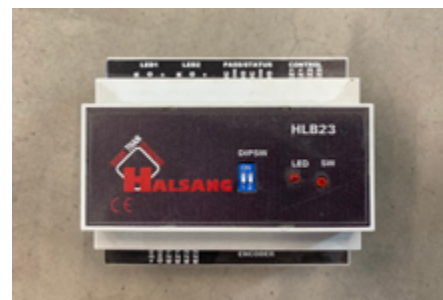
Coffret électrique équipé d'un contrôleur Halsang HLB23
